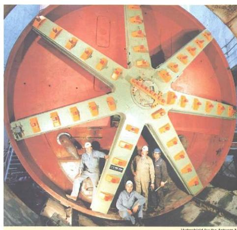
Le premier slurry shield est utilisé en Grande Bretagne en 1960. Mais c'est au Japon que cette technique de creusement sera développée à partir de 1967 par Mitsubishi, puis en Allemagne à partir de 1974 par Wayss & Freitag.
